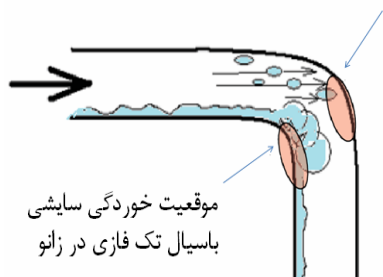
شکل ۳- تأثیر جریان سیال در خم لوله [۵]
