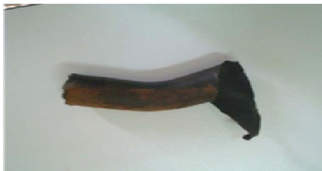
شکل ۱۰- تصویر لوله هارپ گسیخته شده در بویلریک [۶]
