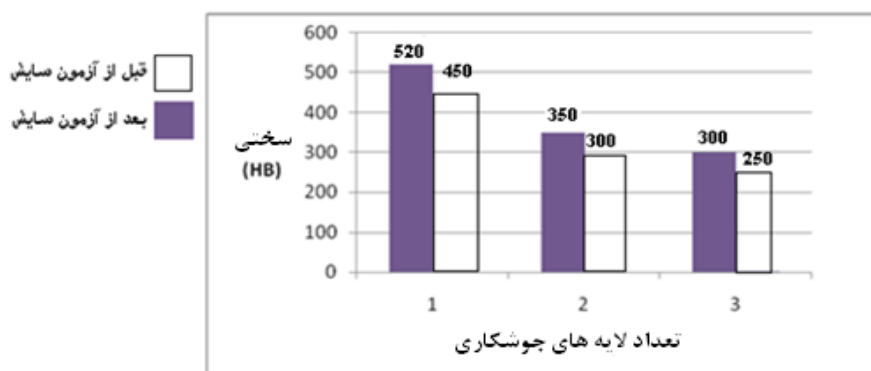
شکل ۵- نتایج آزمون سختی سنجی پیش و پس از آزمون سایش.
