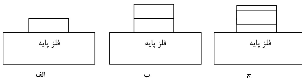
شکل ۱- نمایی از شمار و چگونگی لایه‌ها در نمونه‌های جوشکاری شده الف- تک لایه، ب- دو لایه، ج- سه لایه.
