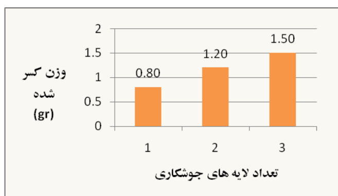
شکل ۶- نتایج آزمون سایش نمونه‌های گوناگون در مسافت ۹۰۰ متر.
