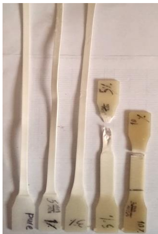
شکل ۹- تصویر بعضی از نمونه‌های کشیده شده در دمای اتاق با نرخ کرنش 1\text{-}5/\text{min}
