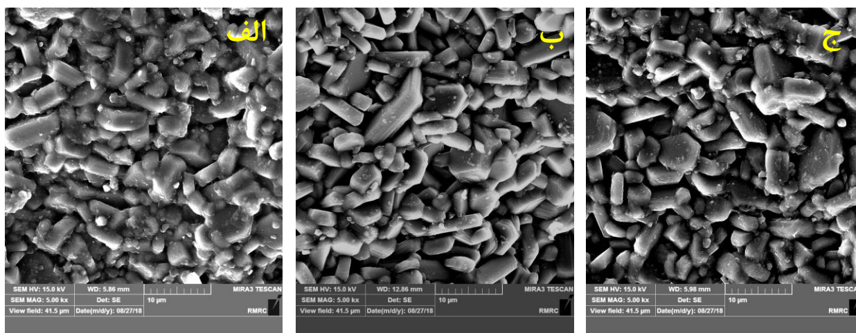
شکل ۹- تصویر FESEM سطح شکست نمونه‌های کاربید سیلیسیم شکل دهی شده توسط ریخته گری زلی و سینتر شده در دمای 2000^{\circ}\text{C} برای درصد‌های مختلف پراکنده ساز: (الف) ۰/۲ (ب) ۰/۴ (ج) ۰/۸
