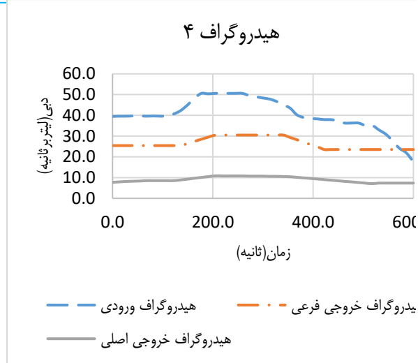
شکل ۴ - هیدروگراف‌های اندازه گیری شده ورودی و خروجی در دبی های مختلف
