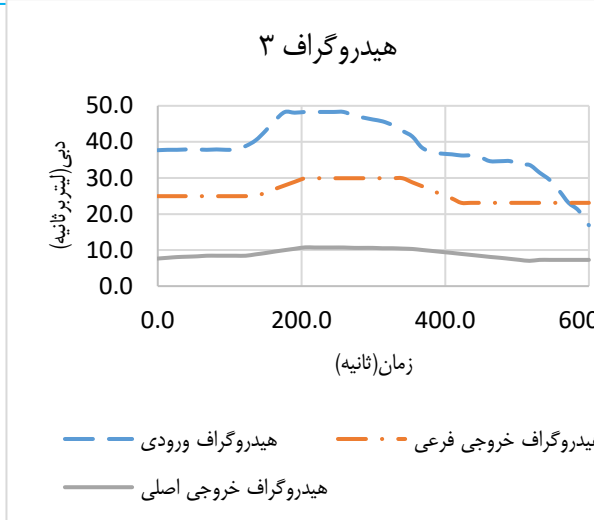
شکل ۴ - هیدروگراف‌های اندازه گیری شده ورودی و خروجی در دبی های مختلف
