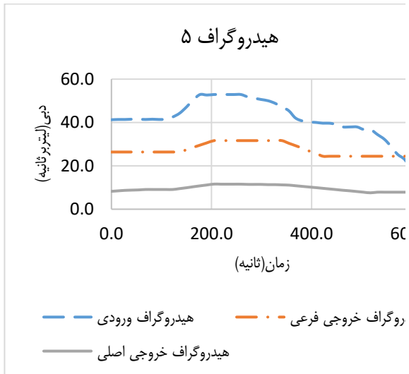
شکل ۴ - هیدروگراف‌های اندازه گیری شده ورودی و خروجی در دبی های مختلف
