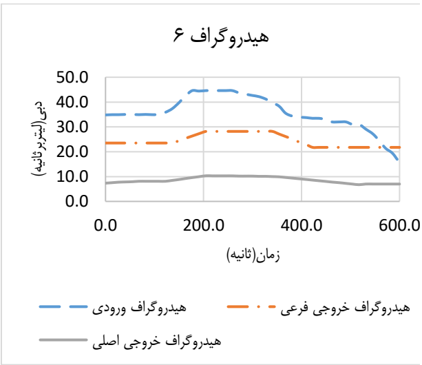
شکل ۴ - هیدروگراف‌های اندازه گیری شده ورودی و خروجی در دبی های مختلف
