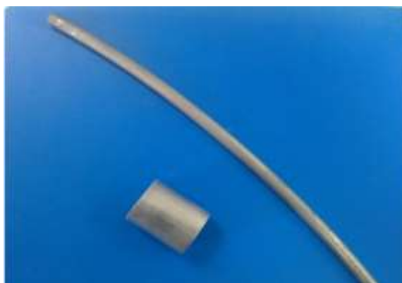
شکل (۱): تصویر ماکروسکوپی نمونه پرس سرد و اکستروژن شده.
