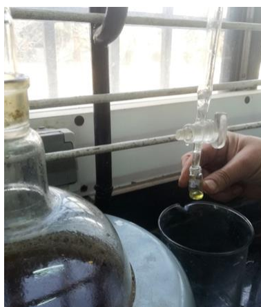
شکل ۳: اسانس‌گیری از سرشاخه گلدار مرزه رشینگری با استفاده از دستگاه کلونجر
