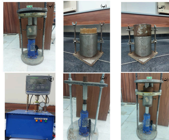
شکل ۳- مراحل ساخت نمونه برای آزمایش مقاومت فشاری محدود نشده (الف: قالب تراکم؛ ب: خاک متراکم شده؛ پ: مغزه گیر سه عددی؛ ت و ث: خارج کردن نمونه از مغزه‌گیر؛ ج: نمونه در حال آزمایش)
