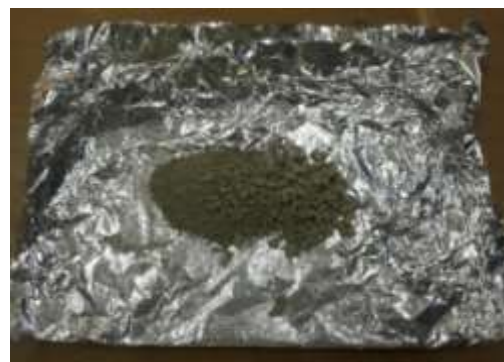
شکل ۳: خرد کردن کاربید سیلیسیم کلوخه شده روی فویل آلومینیومی.
