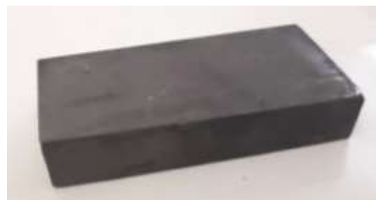
شکل (۱۳): نمونه کاربید سیلیسیم پخت شده.
