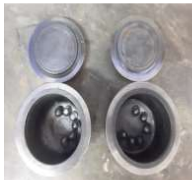
شکل (۲): قرارگیری گوی تنگستنی داخل کاپ.
