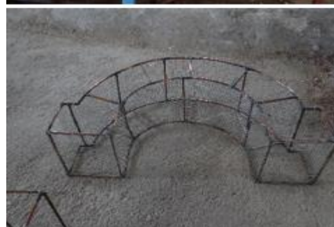
شکل ۱- چند تصویر آزمایشگاهی از سرریز متخلخل قوسی
