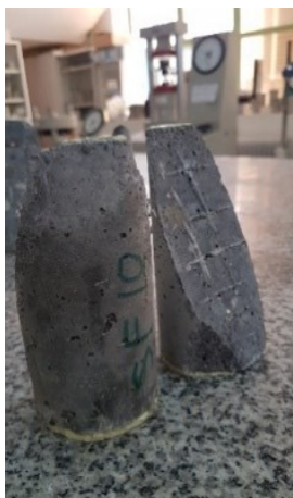
شکل ۱۵- شکست در حالت مود اول نمونه ترمیم شده با ملات پایه سیمانی SF۱۰
