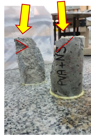
شکل ۱۷- شکست در حالت مود دوم نمونه ترمیم شده با ملات پایه سیمانی PVA-۰/۷۵NS ۶
