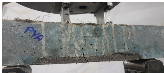
شکل ۹- تست سازگاری بتن پایه ترمیم شده با ملات پایه سیمانی حاوی الیاف PVA
