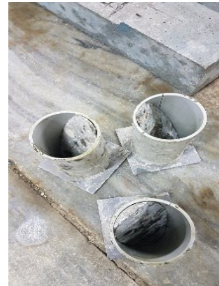
شکل ۱۱- برش نمونه‌های استوانه‌ای بتن پایه و قالب‌گیری مجدد با ملات‌های پایه سیمانی در تست مقاومت پیوستگی
