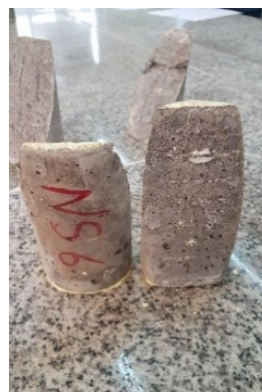
شکل ۱۴- شکست در حالت مود اول نمونه ترمیم شده با ملات پایه سیمانی NS۶
