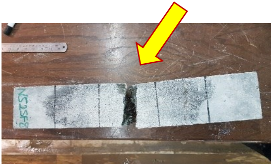
شکل ۱۳- ناحیه شکست تست سازگاری بتن پایه ترمیم شده با ملات پایه سیمانی NS۲SF۸
