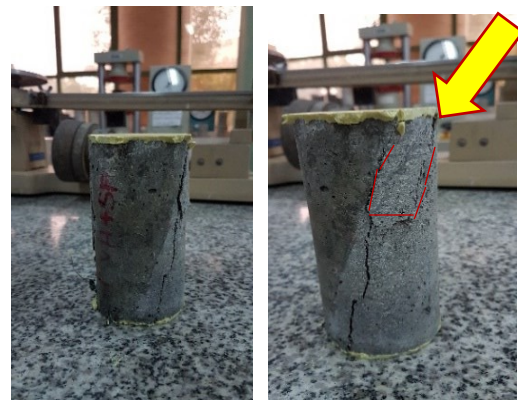
شکل ۱۸- شکست در حالت مود دوم نمونه ترمیم شده با ملات پایه سیمانی PVA-۰/۷۵SF ۱۰
