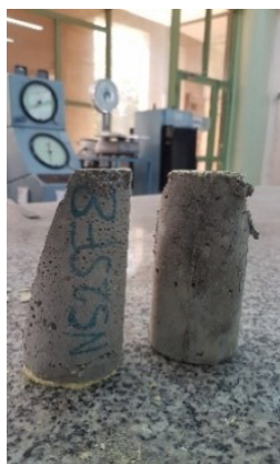
شکل ۱۶- شکست در حالت مود اول نمونه ترمیم شده با ملات پایه سیمانی NS۲SF۸
