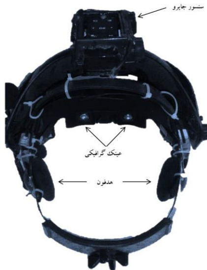
شکل (۷) نمایی از کلاه مخصوص طراحی شده برای قرار گرفتن روی سر بیمار
