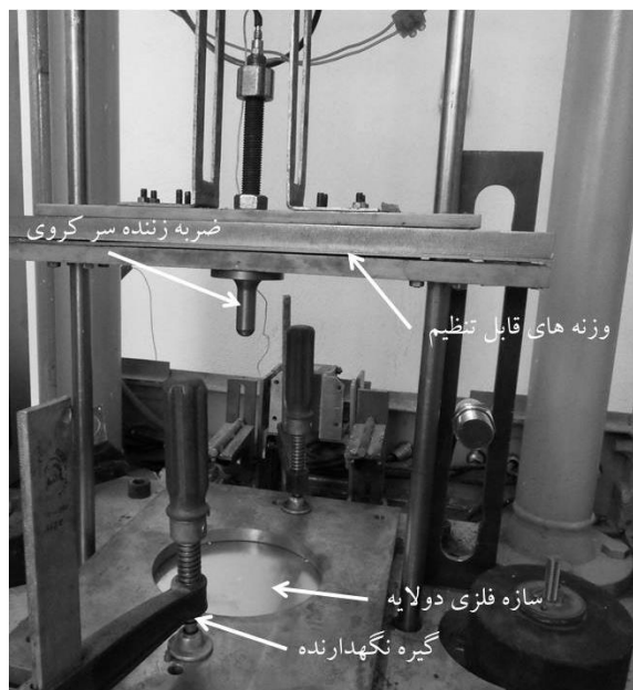
شکل (۴) سازه فلزی دو لایه قرار گرفته در دستگاه تست ضربه.
