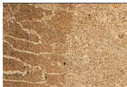
نقطه B (فصل مشترک ناحیه HAZ و FZ) - بزرگنمایی 200X
