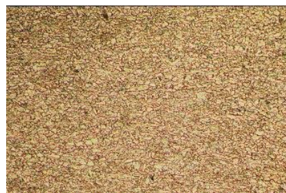
نقطه D (داخل ناحیه BASE) - بزرگنمایی 500X
