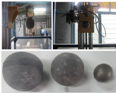
شکل (۱) دستگاه بار افتان گلوله‌ای طراحی و ساخته شده
