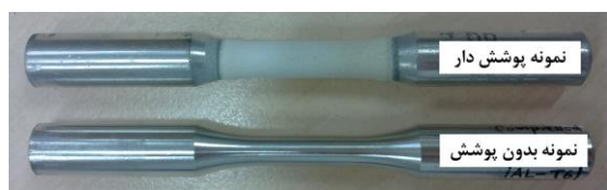
شکل (۱) نمونه‌های آزمون خستگی آلومینیومی با و بدون پوشش.
