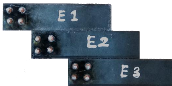
شکل (۲۶) نمونه قطعه فلزی با پین‌های ایجاد شده به روش استاد ولدینگ
