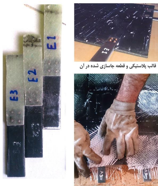
عبور الیاف از دور پین در حین لایه چینی دستی شکل (۲۷) قالب پلاستیکی، لایه چینی دستی و نمونه آماده کاملد
