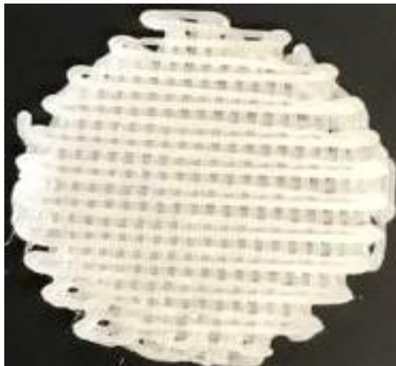
شکل ۱- داربست چاپ سه‌بعدی پلی‌کاپرولاکتون با ابعاد ۱۵ * ۰/۸ میلی‌متر
