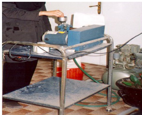
تصویر ۲: آسیاب کردن نمونه های خشک شده جهت انجام آزمایش
