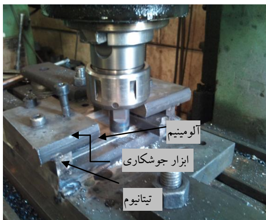
شکل (۲): تصویر دستگاه مورد استفاده و نحوه قرارگیری اجزاء در حین جوشکاری
