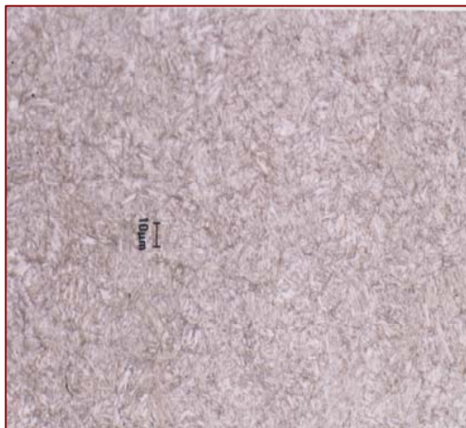
شکل (۴): تصویر متالوگرافی فولاد 30CrMnSi در حالت سخت کاری و تمپر شده در دمای ۴۵۰ درجه سانتیگراد (بزرگنمایی ۵۰۰X)
