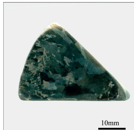
شکل (۵): تصویر ماکروسکوپی قسمتی از شمش همگن شده به مدت ۶ ساعت در دمای ۱۱۵۰°C و ۴ ساعت در دمای ۱۲۰۰°C.
