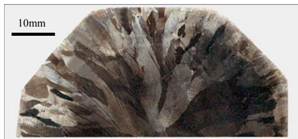
شکل (۷): تصویر ماکروسکوپی نمونه‌ی آهنگری شده تا کرنش حقیقی کل ۰/۲.
