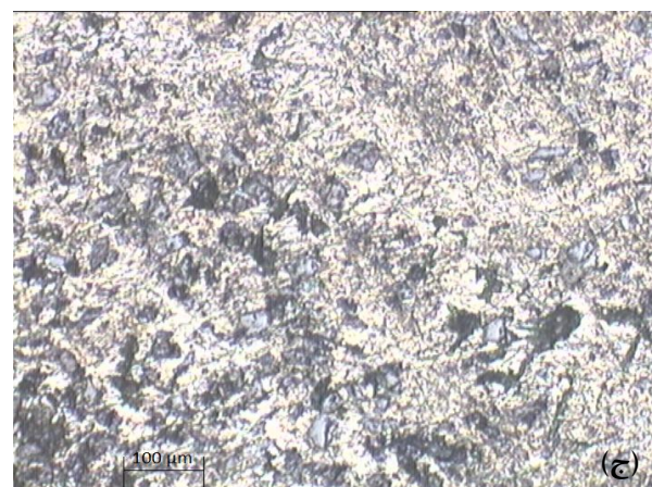
شکل (۳): ریزساختار (الف) A356-5%SiC، (ب) A356-10%SiC و (ج) A356-15%SiC (محلول اچ: ۰/۵ درصد اسید فلوریدریک، زمان اچ: ۳۰ ثانیه).
