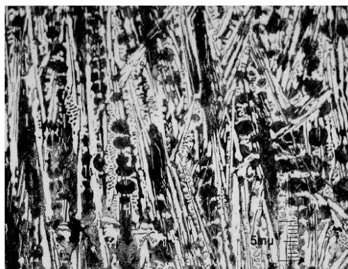
شکل (۴): ریز ساختار سطح نمونه تبریدی به دست آمده توسط میکروسکوپ نوری.
