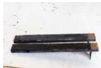
شکل (۷): اعمال مخلوط چسب-گرافن به سطح نمونه‌ها.
