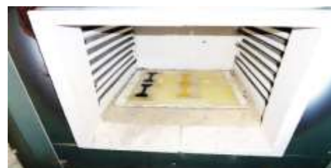
شکل (۵): پخت نمونه چسب در دمای ۶۰ درجه سانتی گراد.
