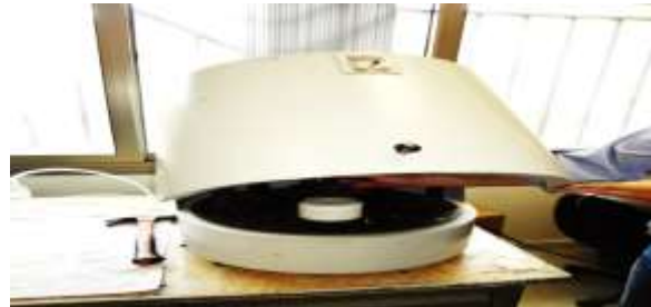
شکل (۳): دستگاه بال میل جهت اختلاط رزین با گرافن.
