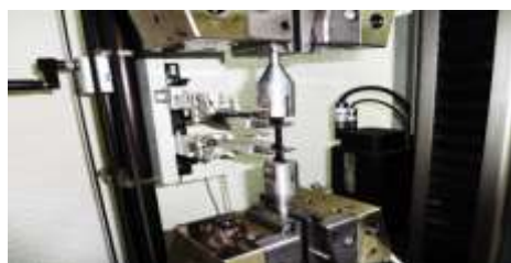
شکل (۶): آزمایش کشش نمونه‌های حجمی چسب.
