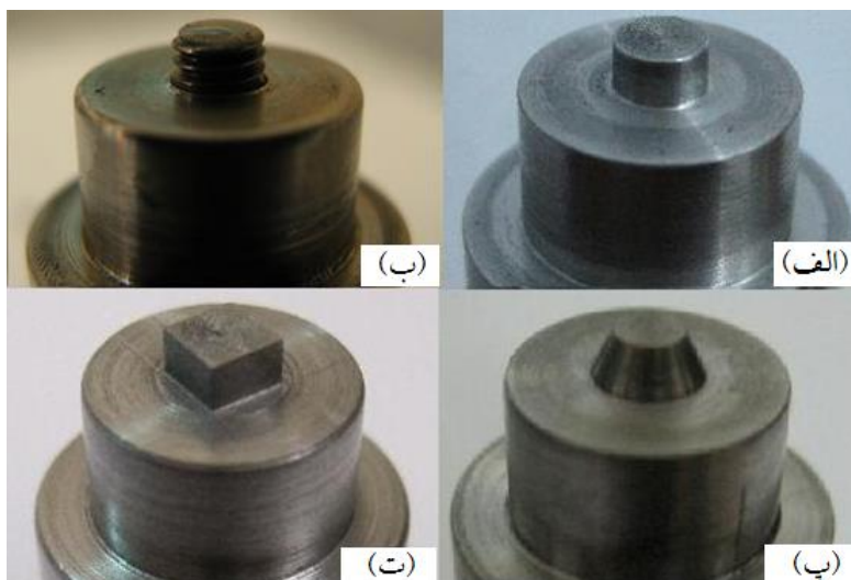
شکل (۲): اشکال مختلف از پین‌های مورد استفاده در این تحقیق. پین (الف) استوانه‌ای ساده، (ب) استوانه‌ای رزوه خورده، (پ) مخروط ناقص و (ت) مکعبی
