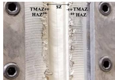
شکل (4): موقعیت نسبی مناطق به هم خورده جوش (SZ)، مناطق متأثر از کار مکانیکی و حرارت (TMAZ)، مناطق متأثر از حرارت (HAZ) و فلز اولیه (BM).
