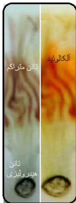
شکل ۲- کروماتوگرافی لایه نازک عصاره خام اندام های هوایی سیاه گینه: چپ- نمایش وجود تانن های متراکم و هیدرولیزی بعد از پاشیدن آهن کلراید. راست- نمایش وجود آلکالوئید بعد از پاشیدن درژاندورف.
