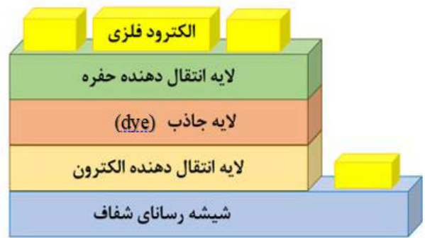
شکل ۱. لایه‌های سلول خورشیدی حالت جامد حساس شده با رنگدانه
