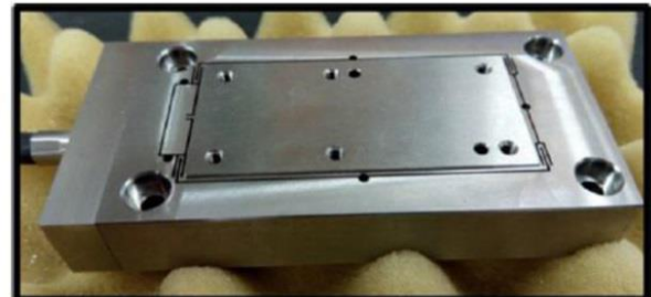
Fig. 2. Piezoelectric actuator (P-752.21).
