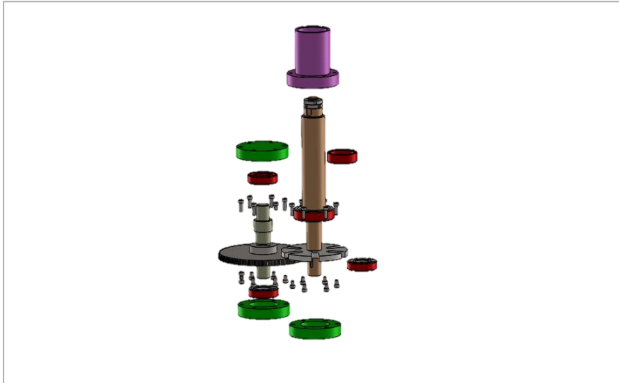
شکل ۱۰: مهار شفت ها با فلنج و بلبرینگ
