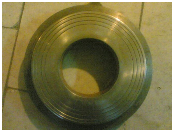
شکل (۶): خط سنترهای ایجاد شده بر روی ورقگیر جهت تنظیم موقعیت دقیق ورق.
