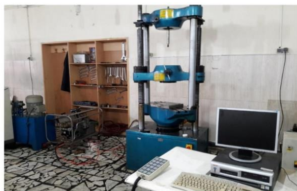
شکل (۱): دستگاه آزمایش انیورسال و سیستم کامپیوتری.
