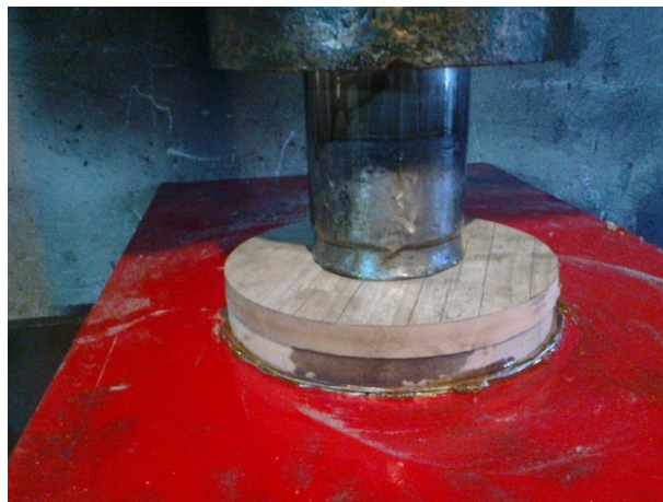
شکل (۵): تحت فشار قرار دادن ورق‌های برنج و آلومینیم در زیر پرس.
