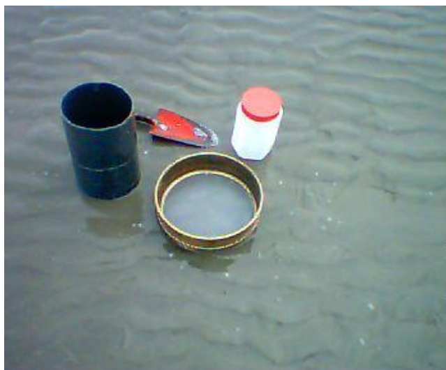
شکل ۴- نمونه بردار مغزه‌ای، بیلچه، الک، قوطی پلاستیکی.
