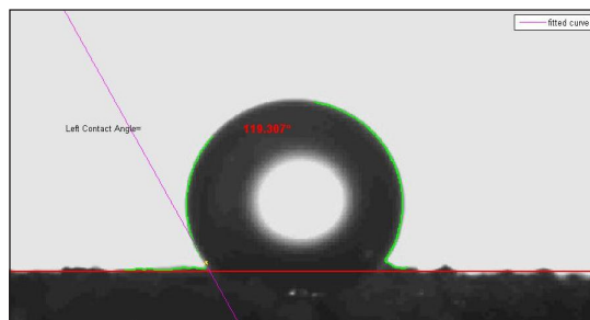
شکل ۱۳ تصویر زاویه تماس قطره کروسیل روی سنگ ماسه‌ای اشباع شده با نمونه سل-ژل در دستگاه
