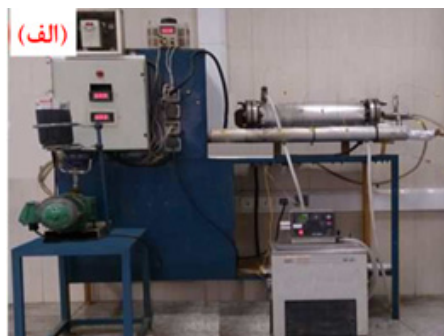
شکل ۱ سامانه آزمایشگاهی تعیین ضریب انتقال گرما جابه‌جایی (الف) و نمودار جریان مربوط (ب)
