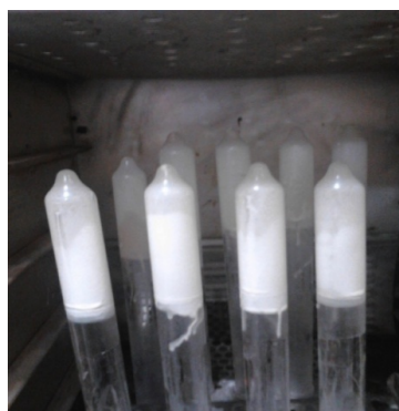
شکل ۱ قالب‌های حاوی نمونه‌های آماده‌شده در داخل آون
