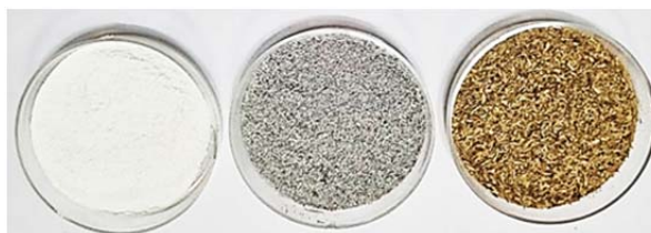
الف ب ج شکل ۲ طرح‌واره کلی از مراحل سنتز: RHs خرد شده (الف)، کلسینه شده (ب) و نانوذره‌های \text{SiO}_2 آریخت (ج)
