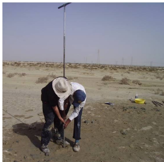
تصویر ۹ - نحوه مغزه‌گیری از رسوبات منطقه ساحلی لیپار
