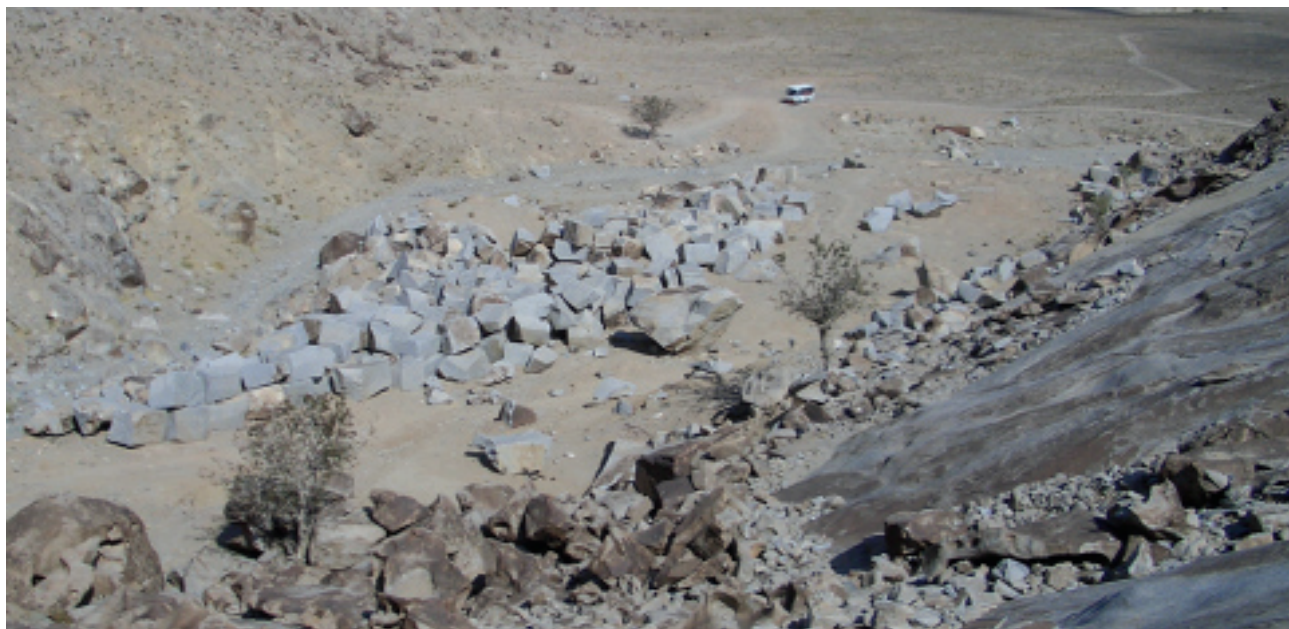
تصویر ۱- معدن گرانتیت لوچان واقع در جنوب غربی زاهدان. بلوک های سالم و غیر هوازده، هر یک به ابعاد حدودی ۲×۲ متر برای تهیه پلاک به کارخانجات سنگ بری ارسال می گردند.
