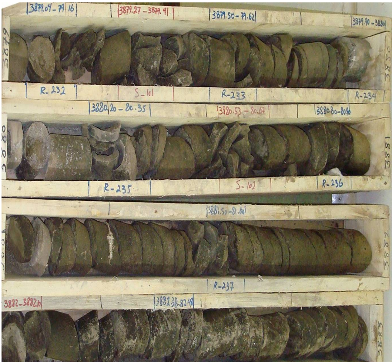
تصویر ۱۰- پهنه شکستگی‌های پشت سر هم در یک زون (Fractures Zone)، شکستگی‌های رهایی (Reales Fractures) و آثار نفت (رنگ تیره)
