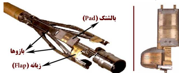
تصویر ۳- نمایی از تصویرگر ریزسازندی (FMI)، بالشتک و زبانه اضافه شده به آن (رضایی ۱۳۸۹)
