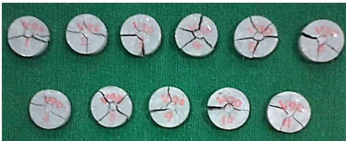
تصویر ۱۰- گسترش ترک‌های کششی بعد از انجام آزمایش پانچ استوانه‌ای در همه جهات بوده و از امتداد ناهمسانگردی سنگ تبعیت نمی‌نماید (نمونه VRK در زاویه ناهمسانگردی ۹۰ درجه).
