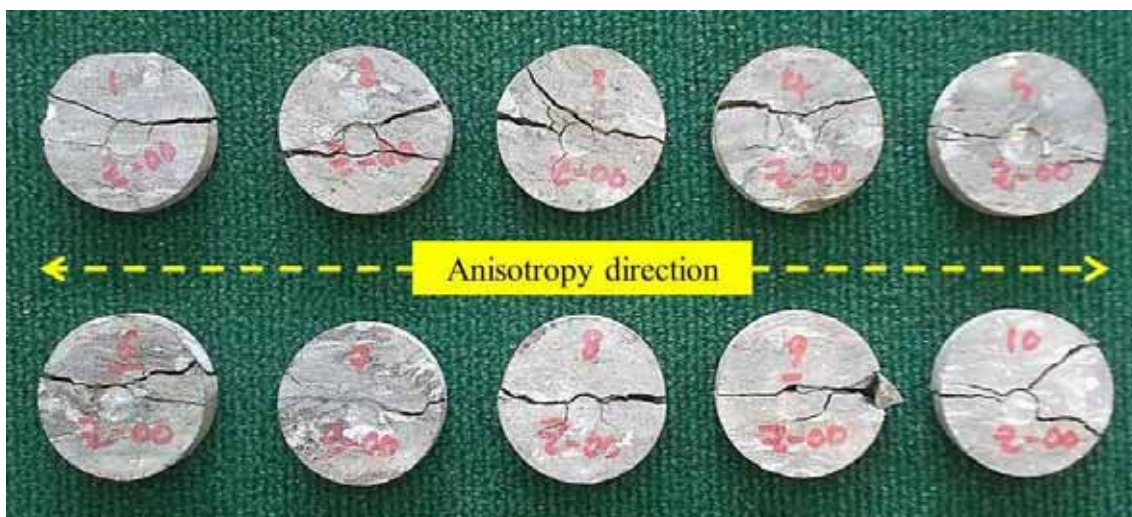
تصویر ۹- گسترش ترک‌های کششی بعد از انجام آزمایش پانچ استوانه‌ای در امتداد ناهمسانگردی سنگ (نمونه ZGH در زاویه ناهمسانگردی صفر درجه)
