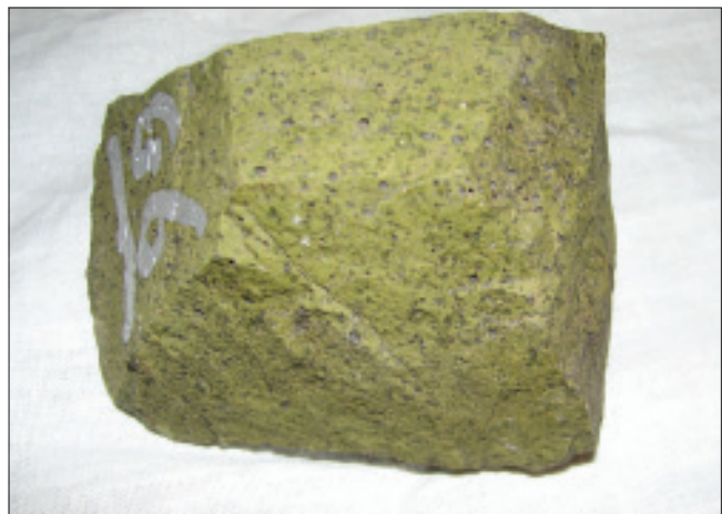
تصویر ۲۲- نمونه‌ای از اپیدوزیت از مقطع چشمه سید ولکانیک‌های مافیک سلطان میدان. بیش از ۹۰ درصد سنگ اپیدوت است و کمتر از ۱۰ درصد سنگ از کوارتز تشکیل شده است.
