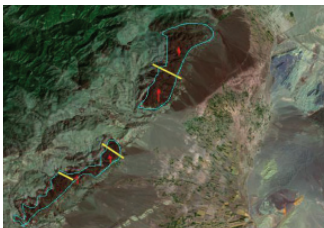
تصویر ۲- تصویر چند طیفی ماهواره‌ی لندست از بازالتهای سلطان‌میدان (ترکیب باندها: R:3, G:5, B:6) فلش‌های قرمز موقعیت بازالتهای سلطان‌میدان را مشخص می‌کنند و خطوط زرد از پایین به بالا نشانگر پیمایش‌های سه‌گانه‌ی کلودر، ابرسج و چشمه سید می‌باشند (مقیاس ۱/۲۵۰۰۰۰).
