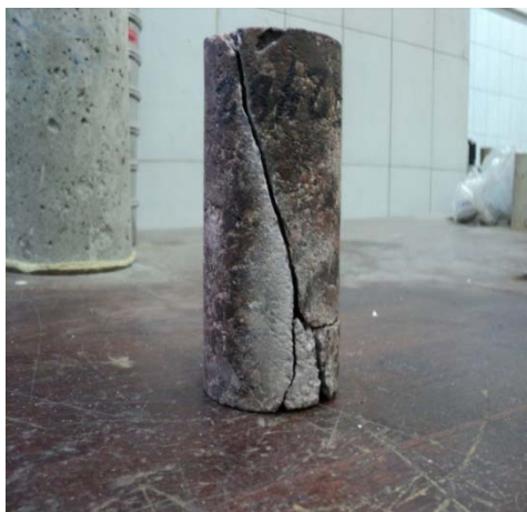
تصویر ۶- شکست برشی در یکی از نمونه‌ها پس از بارگذاری
