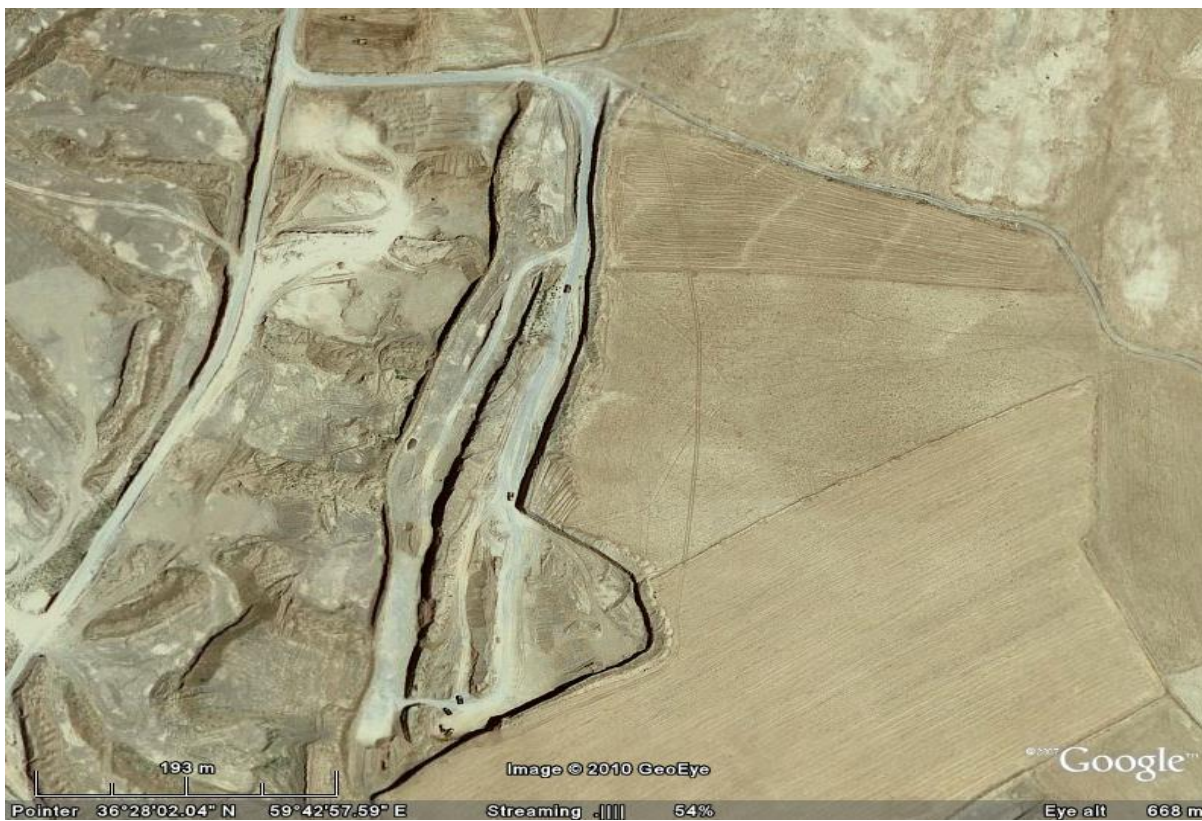
تصویر ۸- حجم بالای گودبرداری برای برداشت مصالح رودخانه‌ای واقع در ۲/۵ کیلومتری جنوب غرب کارخانه سیمان کلات (به مقیاس تصویر توجه شود کامیون‌های ده‌تن که در مقایسه با حجم چاله‌های ایجاد شده بسیار کوچک هستند)
