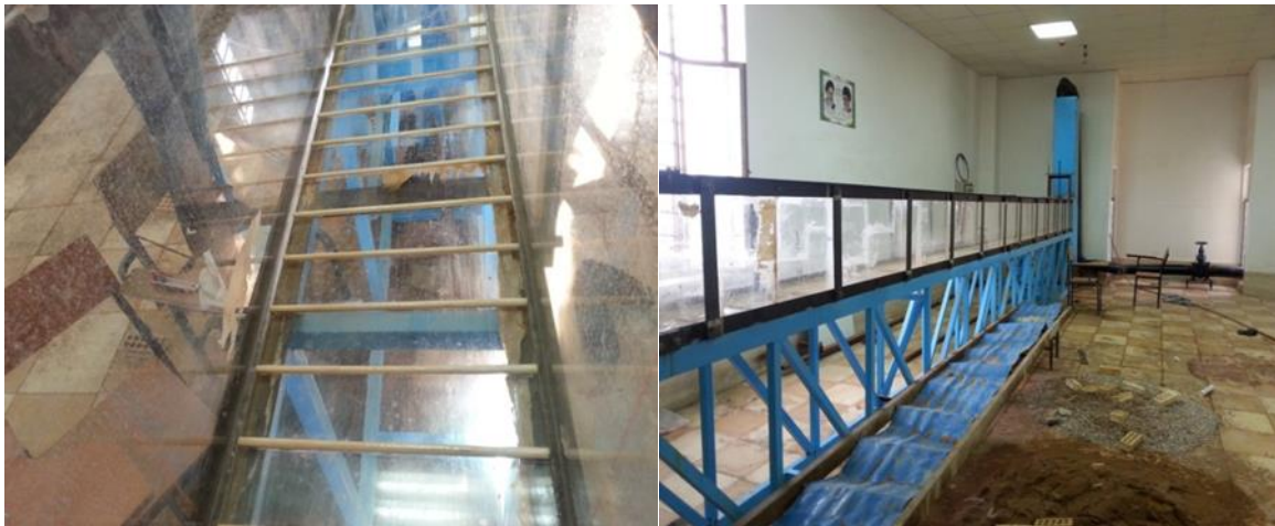
شکل ۲- نمایی از فلوم آزمایشگاهی و زبری های کارگذاری شده در کف فلوم
