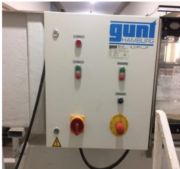
شکل ۷- سیستم برق فلوم
