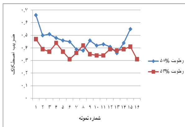
شکل ۲. مقایسه ضریب اصطکاک رزماری روی سطح شیشه‌ای در دو رطوبت مختلف
