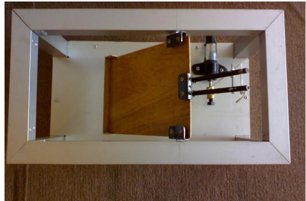
شکل ۱. دستگاه ساخته شده برای اندازه گیری ضریب اصطکاک استاتیکی
