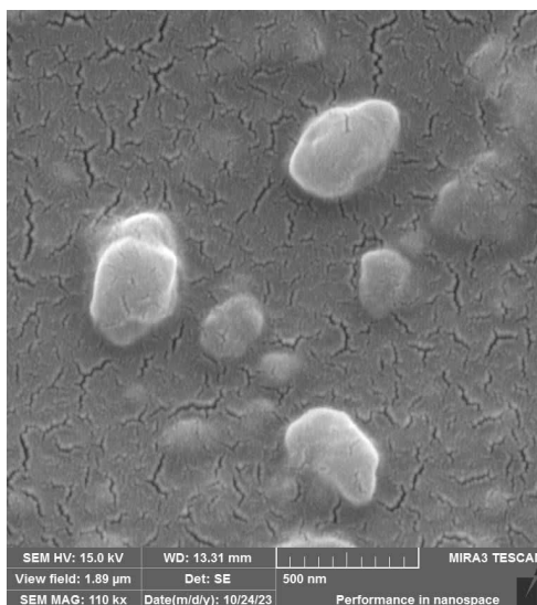
شکل 4 بررسی میکروسکوپ الکترونی روبشی مربوط به زیست کامپوزیت اپوکسی و نانو سلولز با توزیع وزنی 0/5 درصد
