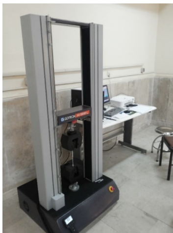
شکل 12 دستگاه تست کشش ساخت شرکت گوتگ کشور تایوان
