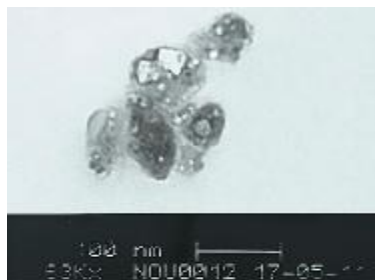
شکل ۳- تصویر میکروسکوپ الکترونی عبوری نانو کپسول اسانس ترخون
