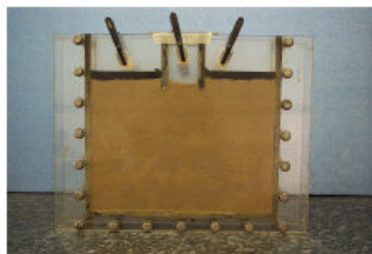
شکل ۳- دستگاه آزمایش انتشار مولکولی دو بعدي، (راست): شکل شماتیک مدل از روبرو، پلان، و مقطع عرضی، (چپ): تصویر واقعی مدل
