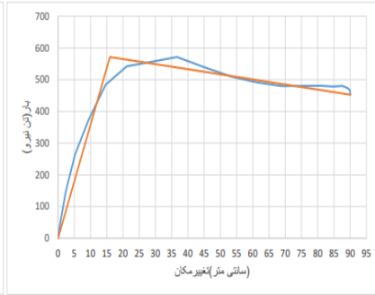
نمودار منحنی بار-تغییر مکان قاب خمشی ویژه ۱۲ طبقه دارای دیوار برشی
